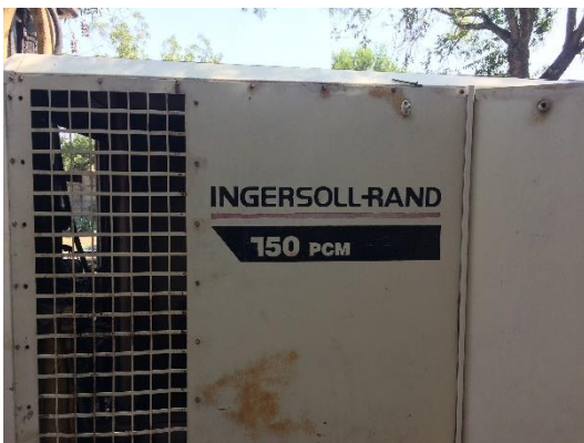
Figura 14. Compresor utilizado para la inyección de soplado
