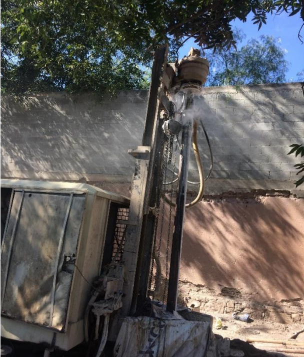
Figura 13. Máquina de perforación adaptada para la penetración
