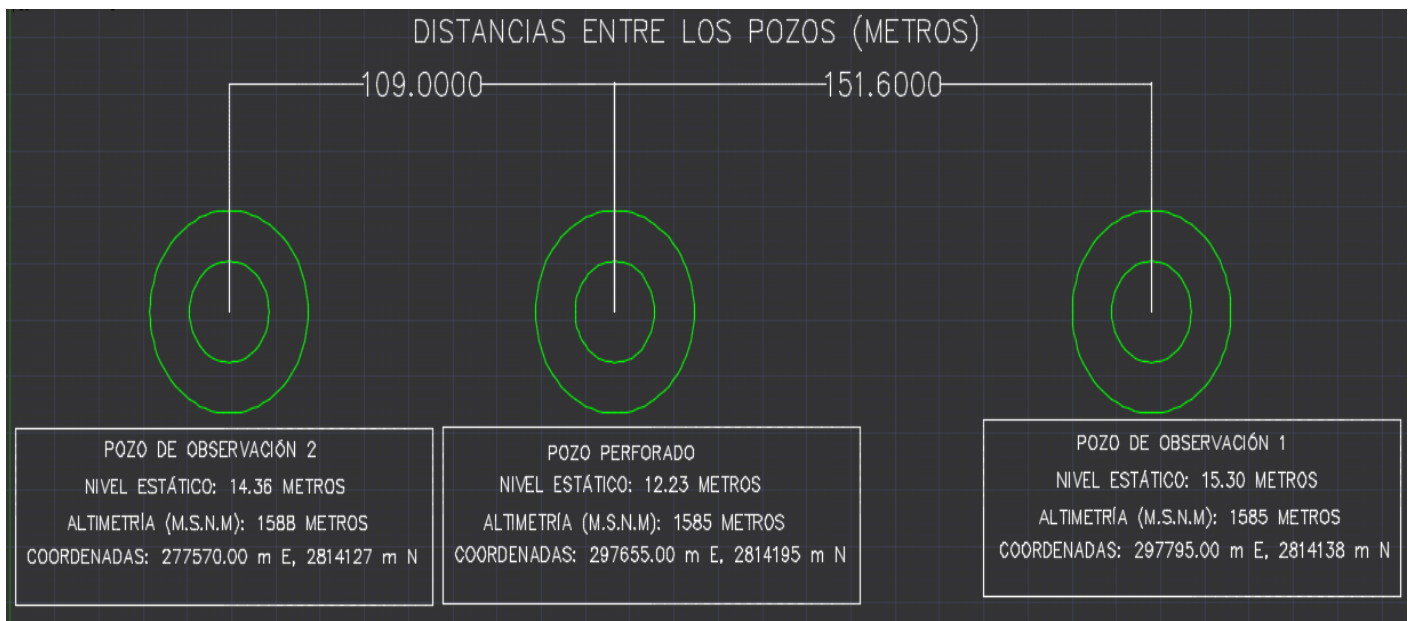
Figura 15. Pozos de observación más cercanos al punto de perforación y sus respectivas características
