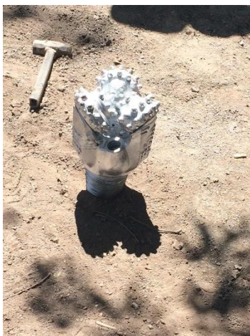
Figura 30. Broca o tricono utilizado en la perforación
