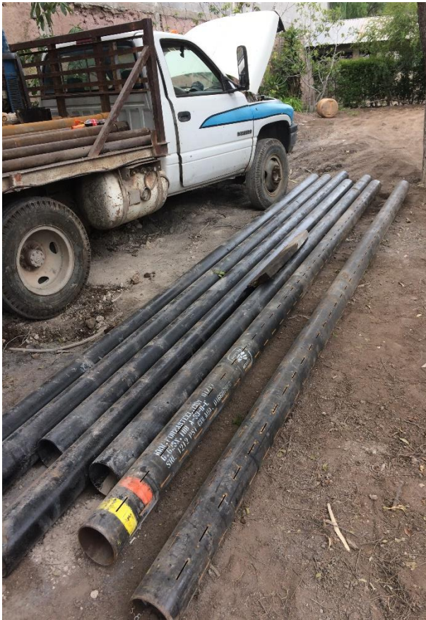
Figura 34. Ademado del pozo
