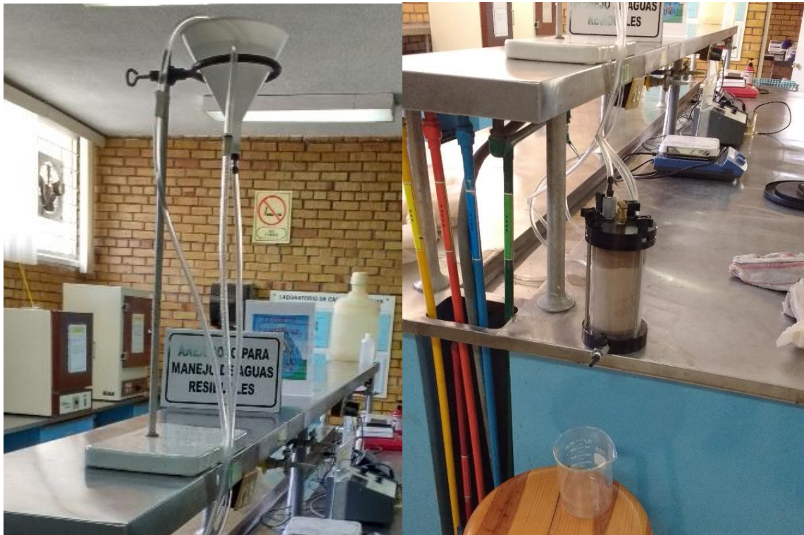
Figura 29. Determinación de la conductividad hidráulica.
