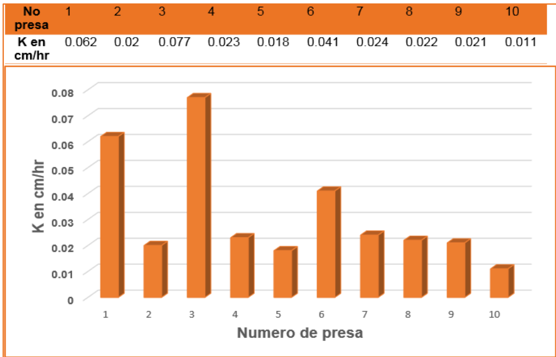
Figura 40. Resultados de la conductividad hidráulica de cada una de las presas.
