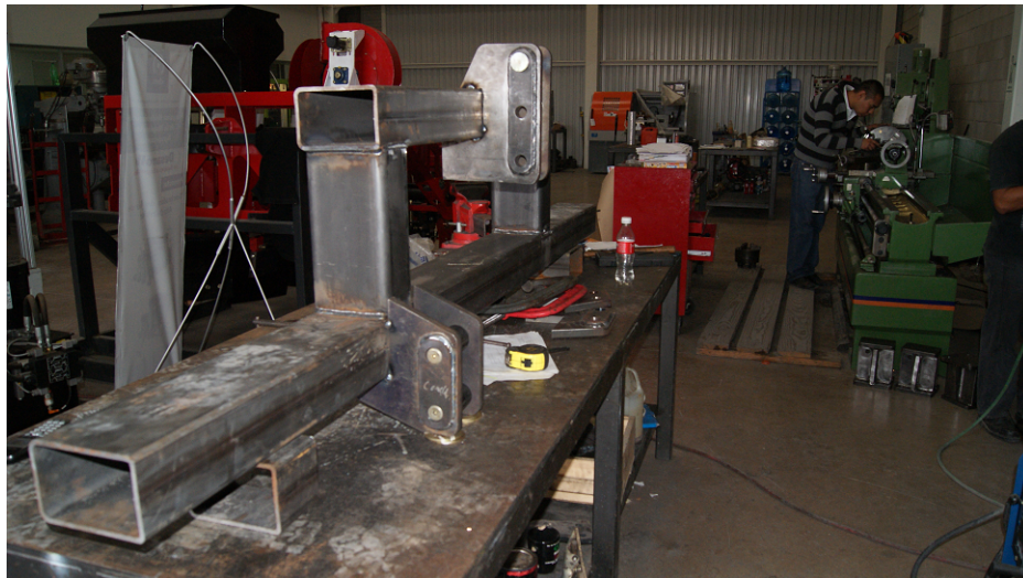
Figura 4.28: Resoldado de bastidor delantero y 3P terminado.
