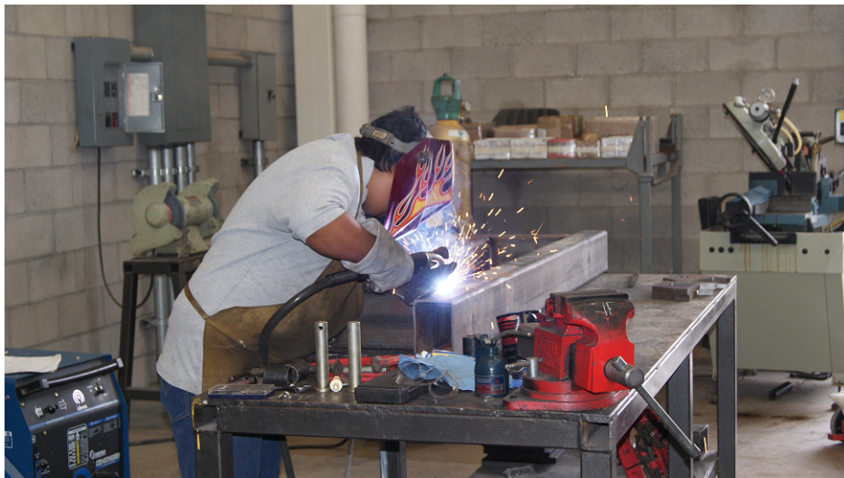
Figura 4.26: Punteado y resoldado con soldadura MIG.
