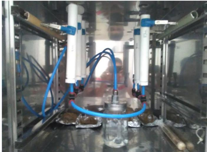
Figura 6. Sistema batch de fermentación en columnas de PVC
