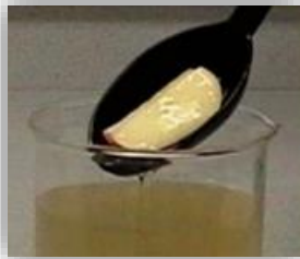
Figura 1. Formación de recubrimientos comestibles (RC) por inmersión del producto.
