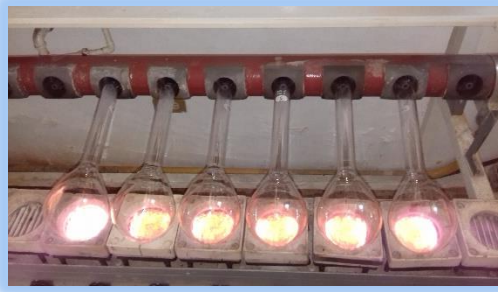
Figura 10. Digestión de muestra de pescado para la determinación de proteína.
