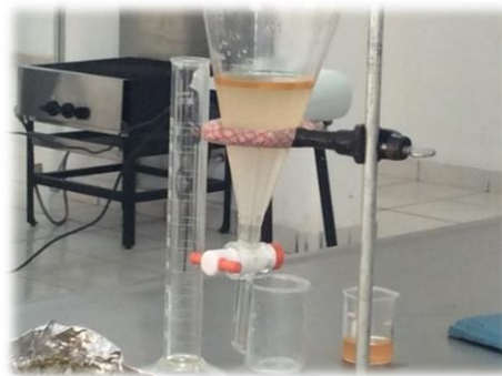
Figura 4. Formación de fases durante la extracción de aceite esencial de tomillo.
