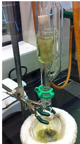
Figura 13. Extracción de grasa en equipo Soxhlet.
