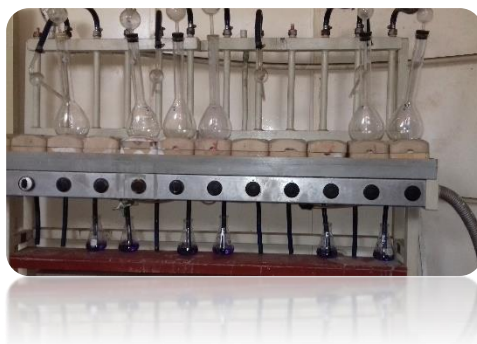
Figura 14. Destilación de filtrado para determinación de NBVT.
