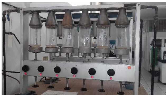
Figura 12. Digestión de muestra de pescado para la determinación de grasa.
