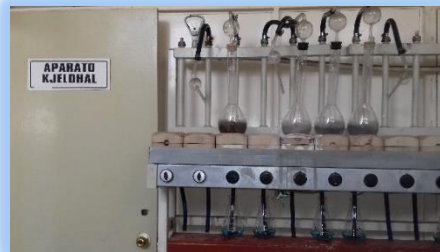
Figura 11. Destilación de la muestra de pescado previamente digerida en aparato Kjeldahl.
