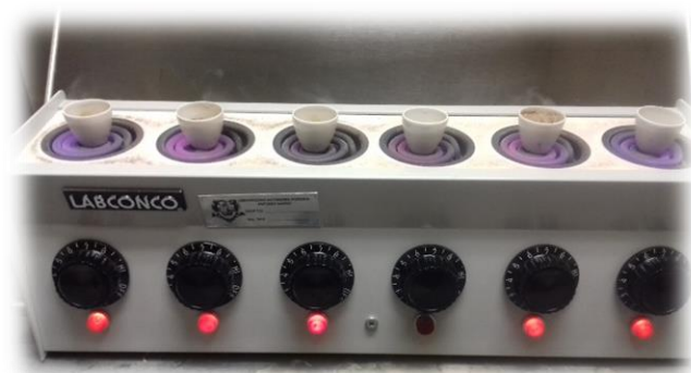
Figura 9. Pre incineración de la muestra de pescado para determinación de cenizas.
