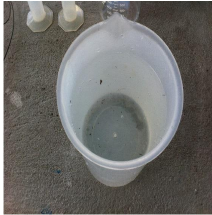
Figura 3.5. Preparación de la solución madre de 2,4-D Amina a una concentración de 400 ppm.
