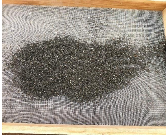
Figura 3.1. Sustrato utilizado en el experimento con un tamaño de partícula de 1.5 a 2 mm de diámetro.
