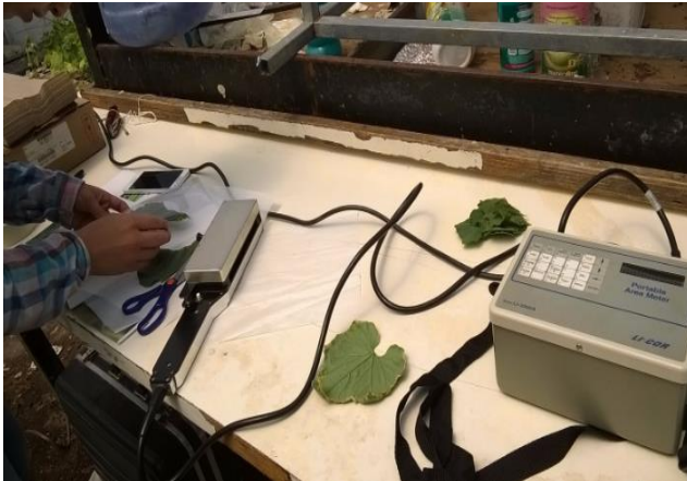
Medición de la área foliar a partir de un medidor portátil modelo LI-500
