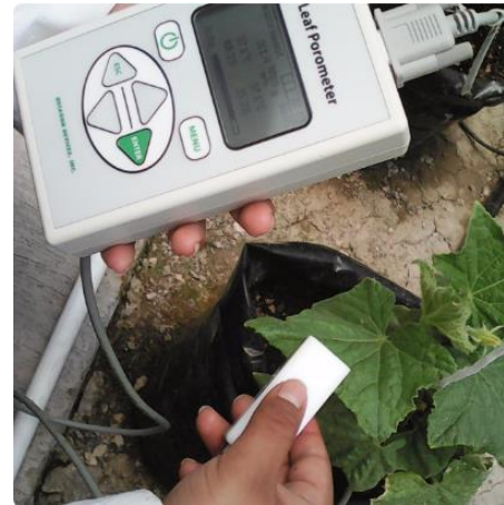
Medición de la conductancia estomática a partir de porómetro digital leaf porometer modelo SC-1
