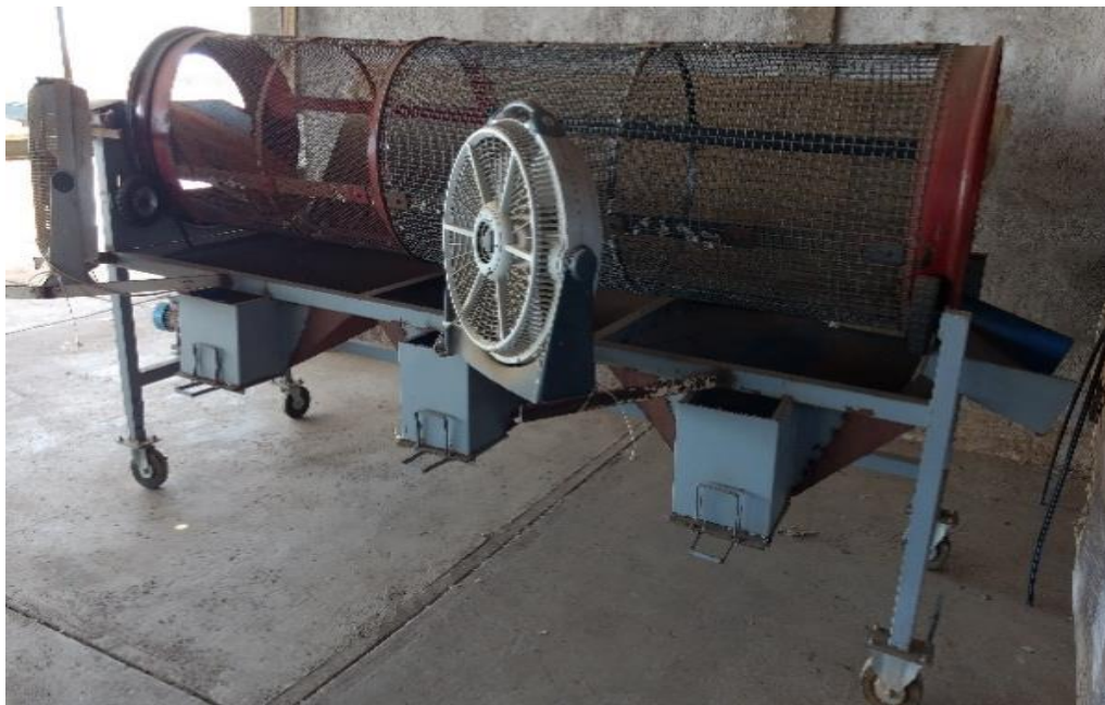
Figura 2. Criba seleccionadora de dientes de ajo.
