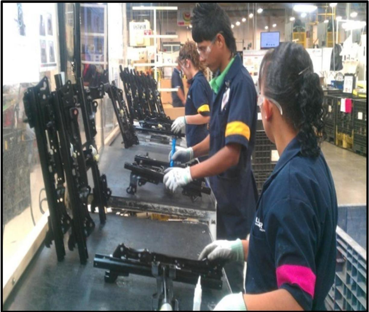
**FIGURA 9. Armado de correderas automáticas**
