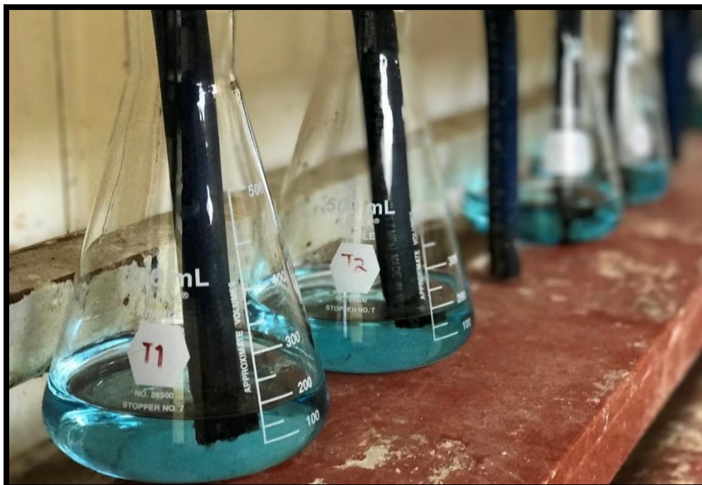
Figura 19. Destilado en forma de amoníaco líquido
