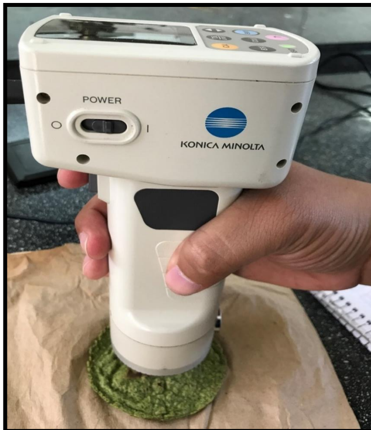
Figura 24. Determinación de color con colorímetro Konica Minolta; Modelo CR-400 Fuente: M.F.S.C., 2017
