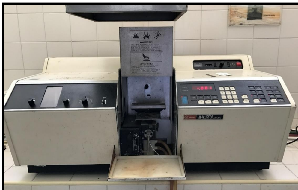
Figura 20. Espectrofotómetro de absorción atómica Marca Varian; Modelo AA-1275
