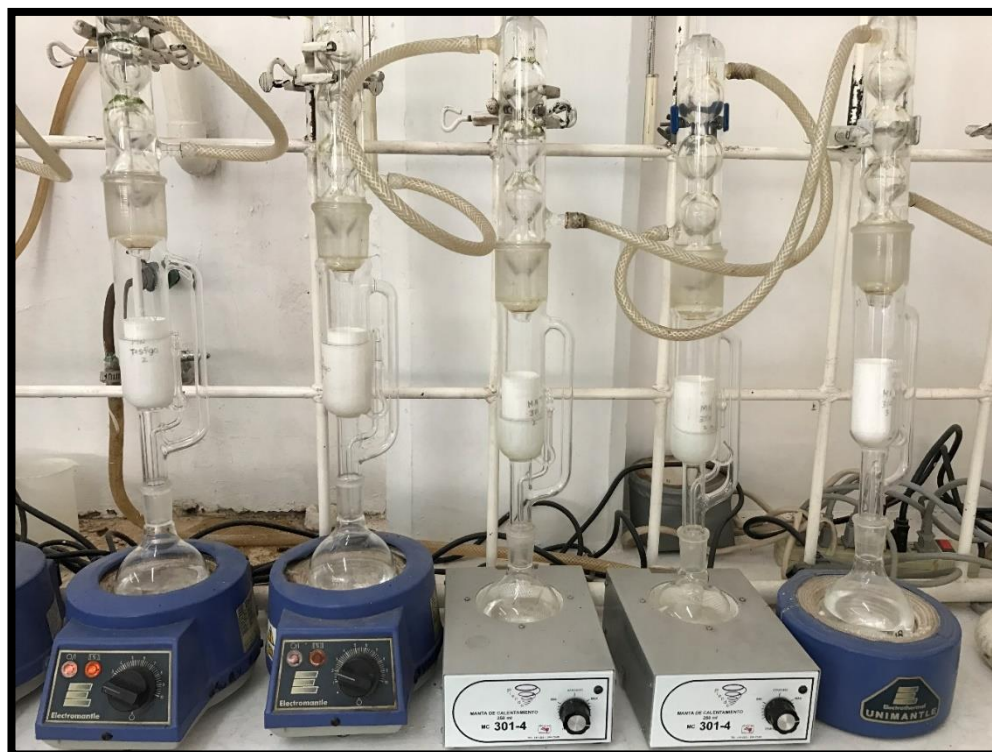
Figura 17. Dispositivo Soxhlet Fuente: M.F.S.C., 2017
