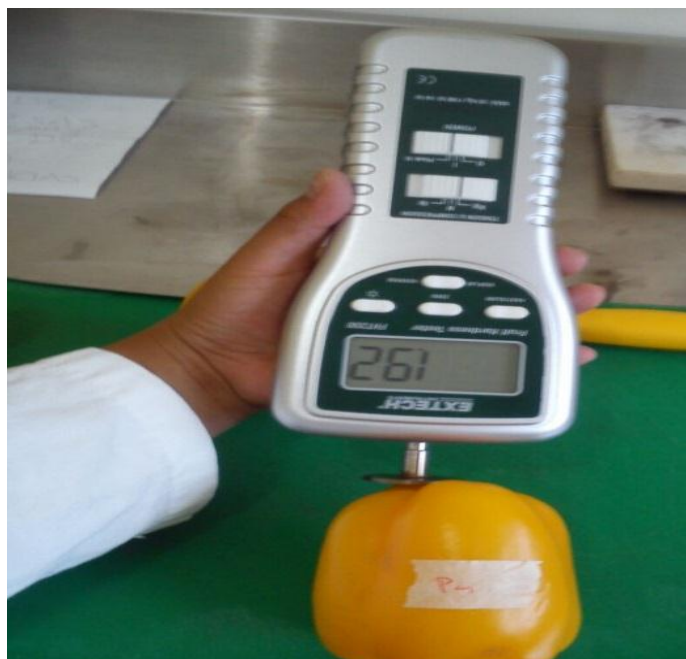
Figura 6. Determinación de firmeza del pimiento morrón.
