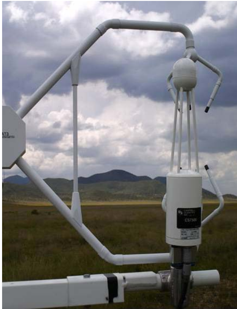
Figura 4.2. Sensores del sistema eddy utilizados para medir los flujos de bióxido de carbono, vapor de agua y calor sobre el pastizal del norte de México.
