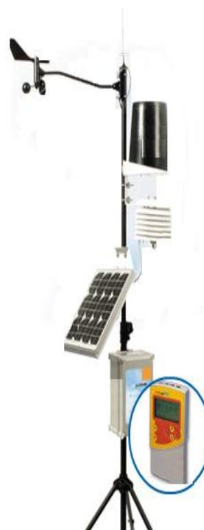
**Figura 2.5** Estación meteorológica automatizada
