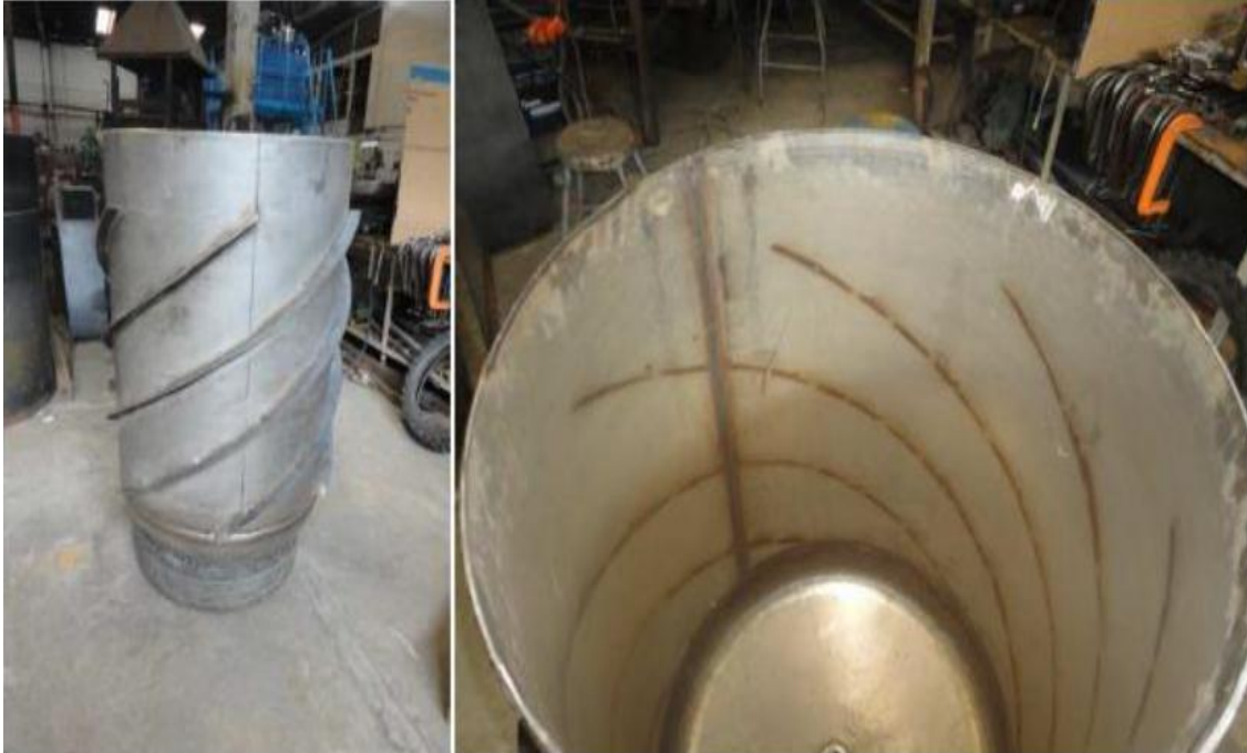
Figura 21. Tanque totalmente terminado con los alerones que reducen el flujo de calor (Aguilar, 2012).
