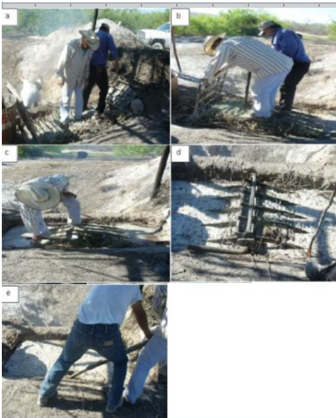
Figura 13. Proceso de inmersión de la candelilla: a) se comprime la planta en la paila; b) se cierra una de las dos parrillas; c) se cierra la otra parrilla; d) se sumerge la candelilla que queda en la orilla de la paila; e) se prensa la planta con las parrillas (Ochoa-Reyes et al. , 2010).
