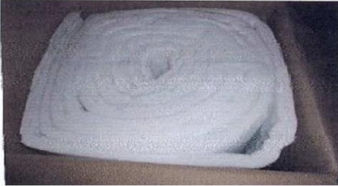
Figura 24. Fibra de cerámica colocada como aislante térmico entre la cámara de calor y el tanque (Aguilar, 2012).
