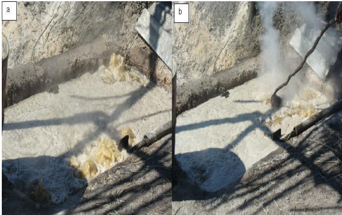
Figura 14. a) Punto de ebullición; b) adición de ácido sulfúrico (Ochoa-Reyes et al. , 2010).
