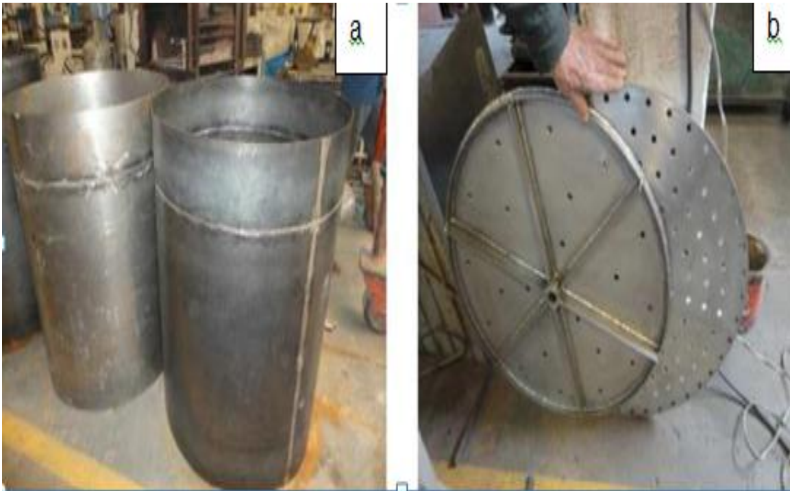
Figura 22. a) Cámaras de calor de los equipos; b) rejas superior e inferior de los mismos (Aguilar, 2012).
