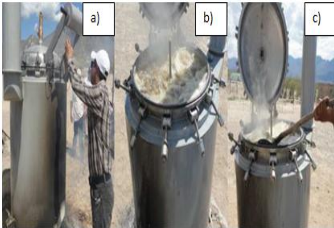
Figura 26. Proceso de extracción de cera de candelilla: a) cierre total del equipo extractor; b) punto de ebullición; c) retiro de la cera espumosa (Aguilar, 2012).
