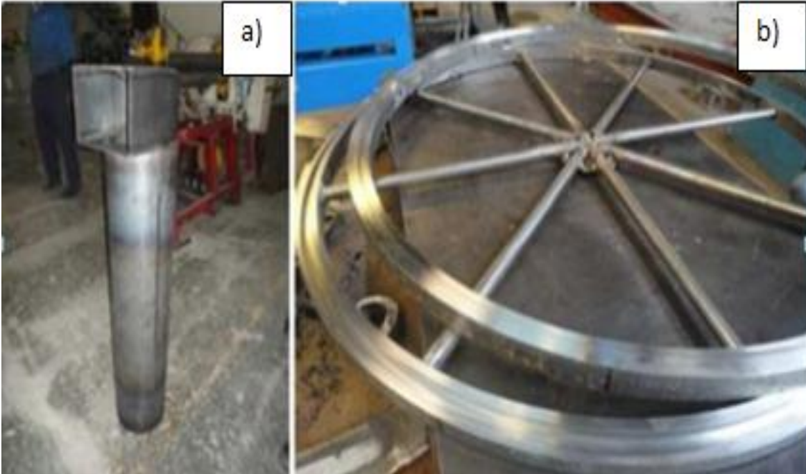
Figura 23. a) chimenea para favorecer el tiro de los gases; b) cierre hermético de los equipos para el máximo aprovechamiento del calor (Aguilar, 2012).
