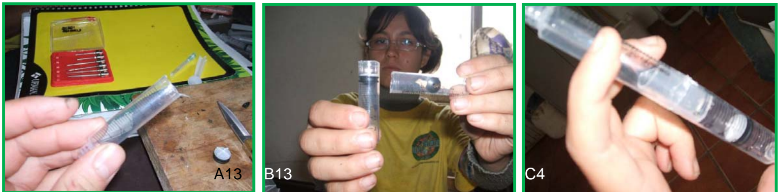
FIGURA 27. Representaciones gráficas sobre la realización de dardos. Se le cortan las “orejitas” a la jeringa en el paso 1 (A13), la goma con émbolo va en una jeringa y la goma sola en la otra en el paso 4 (B13), un trozo de jeringa más chico une las dos grandes en el paso 5 (C 4).
