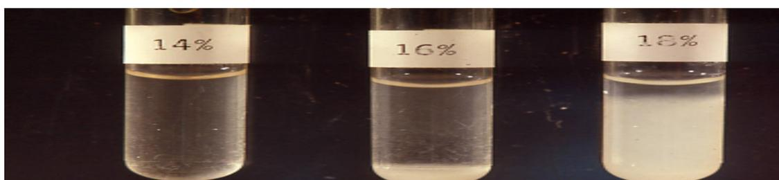
**Figura 5.** Precipitación del sulfito de sodio en diferentes porcentajes
