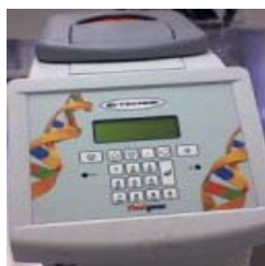
Figura. 2. Termociclador en el cual se hace una mezcla rápida de calor y frio de acuerdo al ciclo programado para PCR
