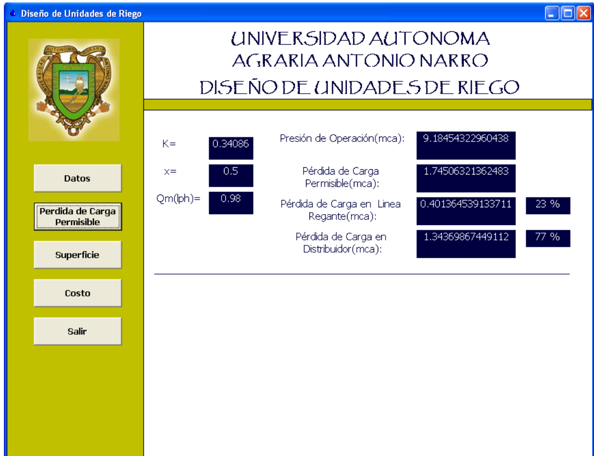
Figura 5. Pérdida de carga permisible y presión de operación del sistema de riego localizado. UAAAN UL 2010
