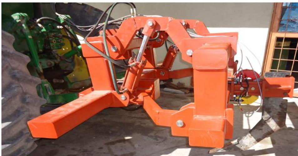
**Fig. 3.4.** Vista de los actuadores hidráulicos en el prototipo de labranza inteligente.
