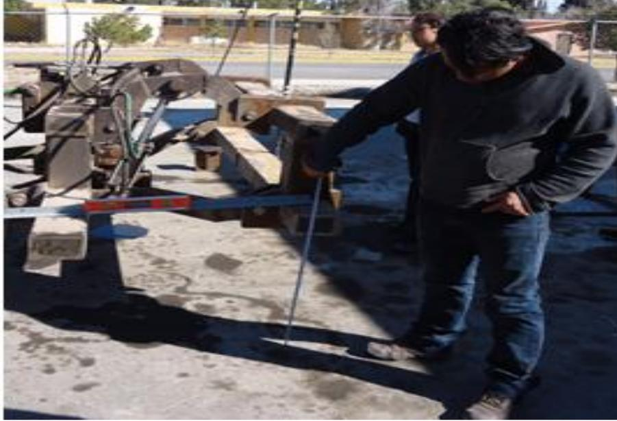
**Fig. 4.17.** Recorrido de la parte articulada con respecto a la parte fija del prototipo de labranza inteligente.
