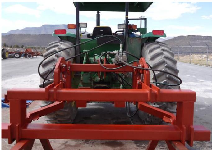
**Fig. 4.15.** Prototipo de labranza inteligente con válvula electrohidráulica.
