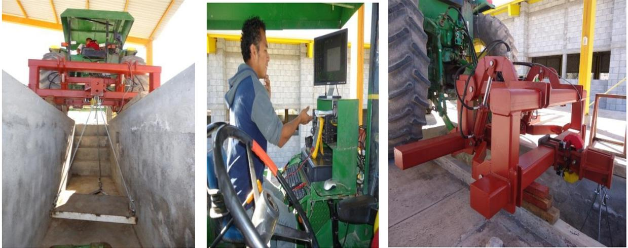
**Fig.4.4.** Proceso de calibración y registro de la fuerza vertical (FY) aplicada al Octagonal Extendido.
