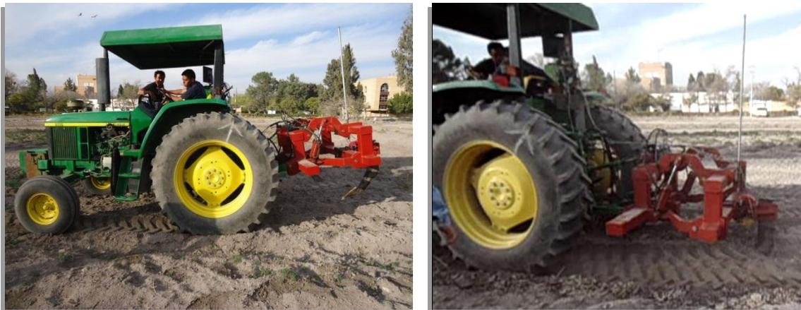
**Fig. 3.3.** Obtención de las fuerzas FX, FY, y Momento en campo.
