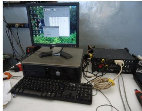
**Fig.4.1.** Proceso de calibración y registro de la fuerza horizontal (FX) aplicada al Octagonal Extendido.
