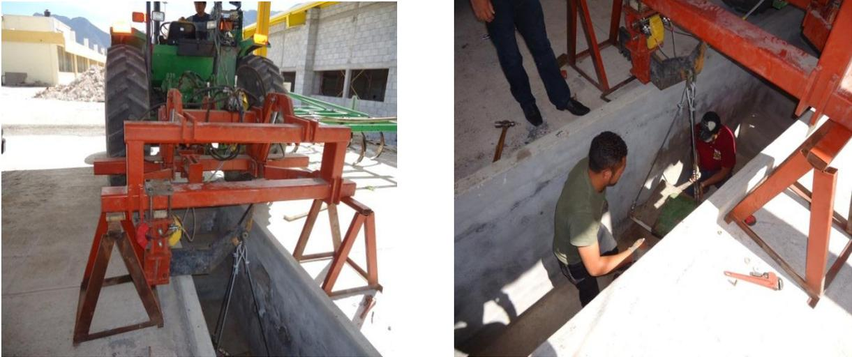
**Fig. 4.7.** Proceso de calibración y registro del Momento (M) aplicado al Octagonal Extendido.
