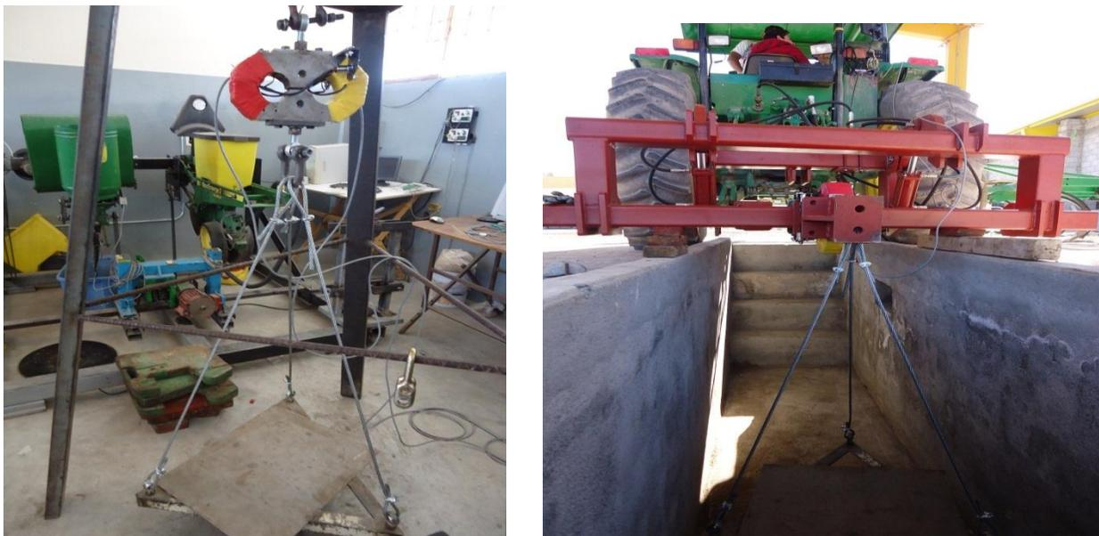
**Fig. 3.2.** Obtención de las constantes FX, FY y Momento.
