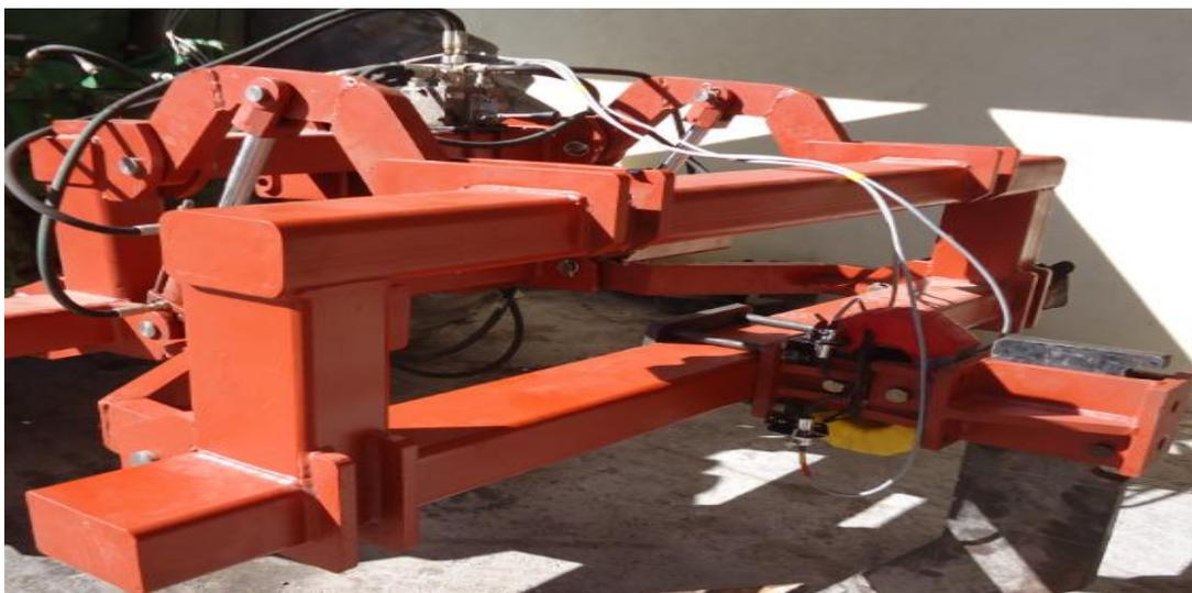
**Fig. 4.16.** Prototipo de labranza inteligente para la medición de pulsos arrojados y distancia recorrida por los actuadores hidráulicos.
