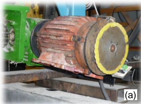
Figura 3.6. (a) Motorreductor 1:30. (b) Sensor de semilla
