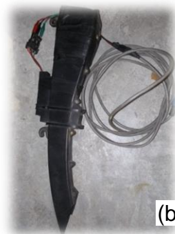
Figura 3.6. (a) Motorreductor 1:30. (b) Sensor de semilla
