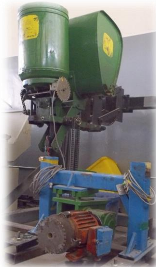
Figura 3.5. Sistema dosificador mecánico.
