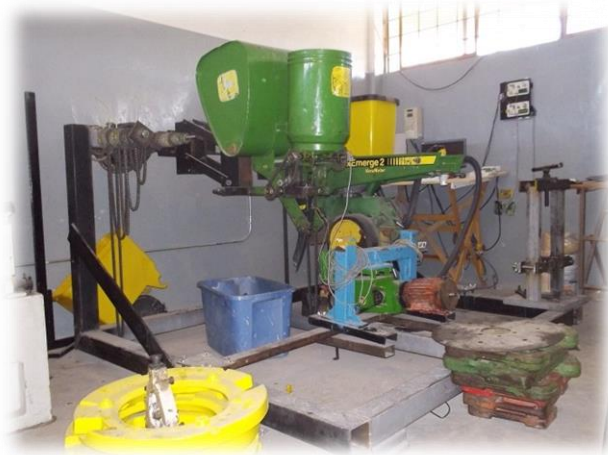
Figura 3.3. Banco de pruebas del sistema dosificador neumático y mecánico.
