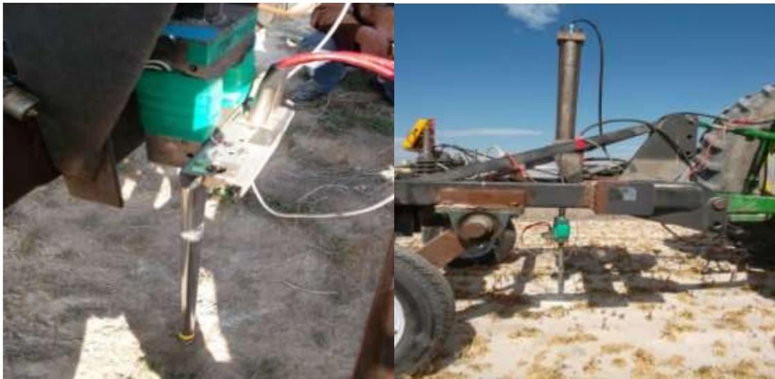
FIGURA 4.32. Evaluación encampo para determinar la resistencia a la penetración a diferentes profundidades y generación de mapas con sistema de información geográfica.
