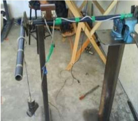
FIGURA 3.21. Proceso de pruebas en laboratorio del sensor de cohesión y contrapesos empleados en la calibración.
