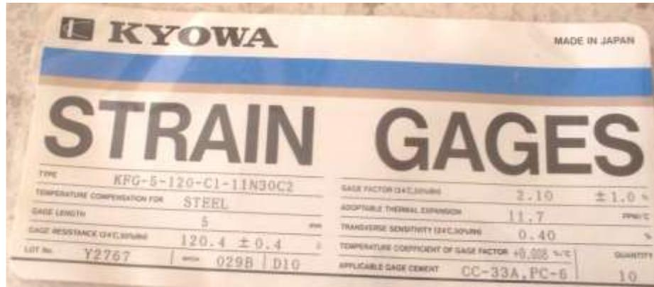
FIGURA 4.29. Especificaciones de galgas extensiométricas empleadas en el elemento sensor, en arreglos de puente de wheatstone.
