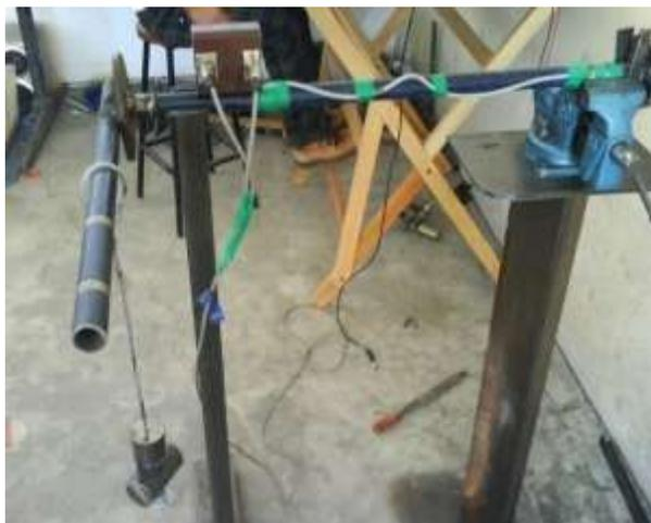
FIGURA 4.40. Cargas y descargas considerando pesos y distancias para la calibración del sensor de esfuerzo a la falla del suelo. A una posición de la fuerza de 18, 28, y 38 cm con respecto del centro del sensor.
