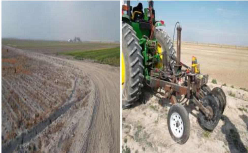
FIGURA 3.25 predio, Tractor y carro porta sensores empleados en campo para medir la resistencia a la penetración en el campo experimental rancho navidad.
