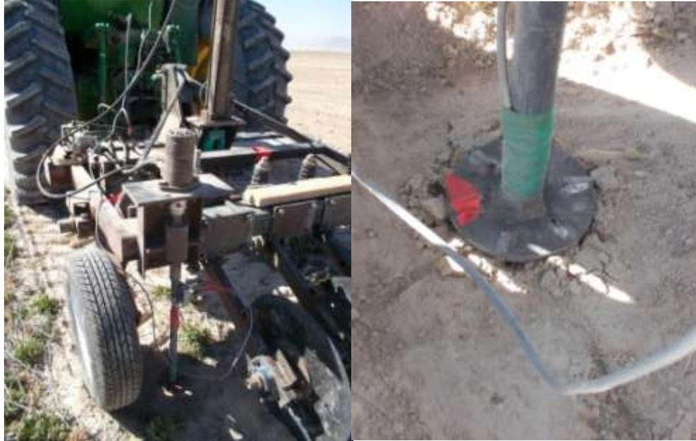
FIGURA 4.42. Evaluación encampo para determinar la demanda de fuerza para la falla del suelo.
