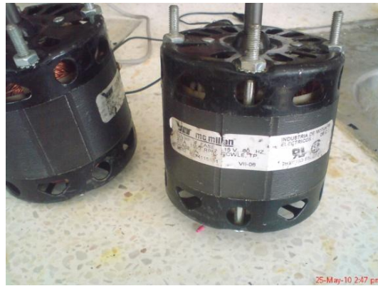
Figura 3.3 motores de 115 volts.
