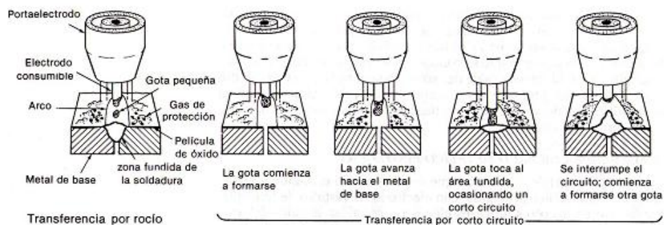
Fig.35 Métodos de transferencia del metal en la soldadura de arco metálico y gas.
