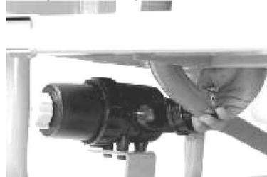
Figura 7.8 Manguera de salida del filtro
