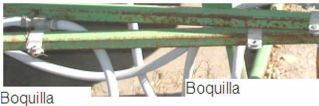
Figura 4.4 Barra porta boquillas
