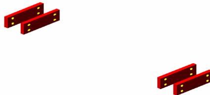
Figura 4.20. Soleras perforadas que sujetan a la estructura del robot y a su vez al chasis de éste, por medio de tornillos.
