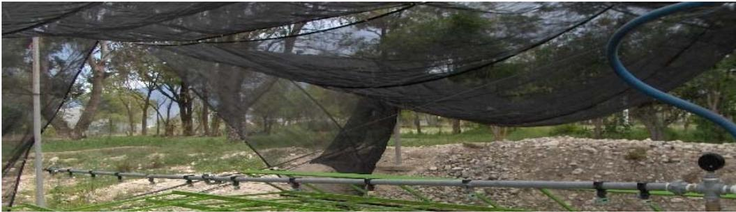
Figura 4.13. Aguilón de robot de riego marca Combi Boom el cual esta sostenido por medio de cables.
