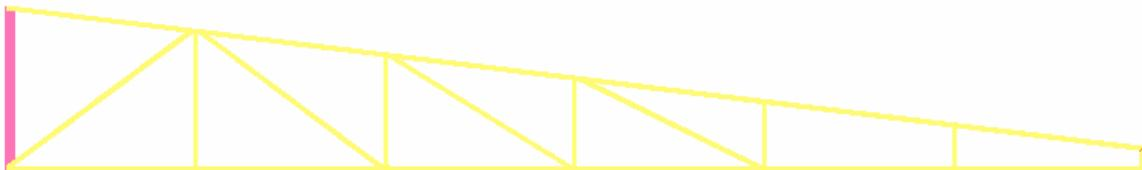
Figura 4.14. Aguilón propuesto para el nuevo sistema de riego el cual esta construido de tubular 1"X1/16", excepto la base que es de ángulo de 2"X 3/16".
