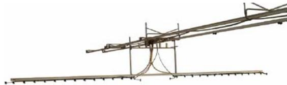
Figura 2.7. Sistema de riego aéreo móvil usado en viveros.
