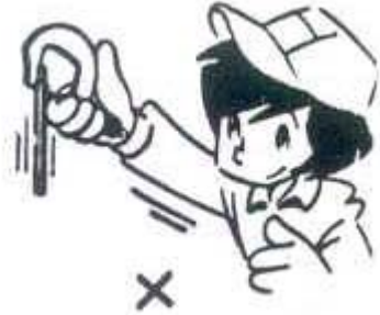
Figura 7.5 No levantar el micrómetro con el objeto
