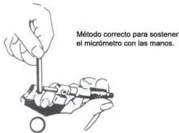
Figura 7.2 Sostenimiento del micrómetro
