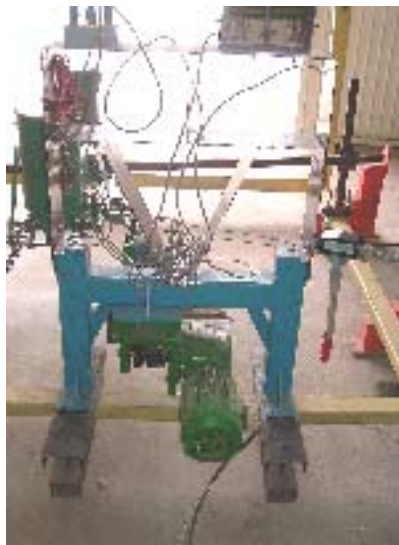
Fig. 4.16 Banco de prueba con Motóreductor de .5 hp.
