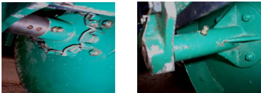
Fig. 4.14 Lubricación a ambos lados del eje de la rueda motriz.
