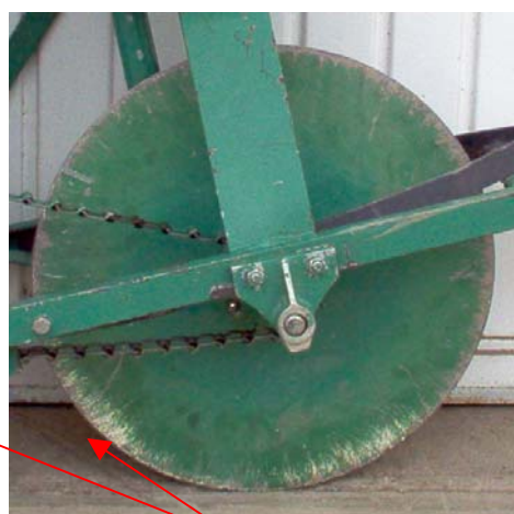
Fig. 4.13 Rueda motriz contacto con el suelo.
