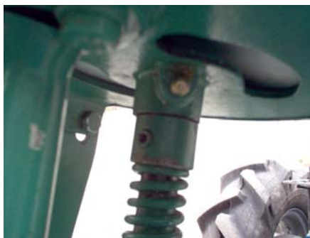
Fig. 4.15 Lubricación en el eje del dosificador de semillas.
