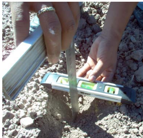
Fig.4.21 Medición de la profundidad.
