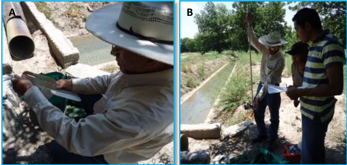
Figura 3.4 Ensamblado del instrumento hidrométrico Gurley 622. (Fotografías tomadas por Norma Noemí Morales Pérez).
