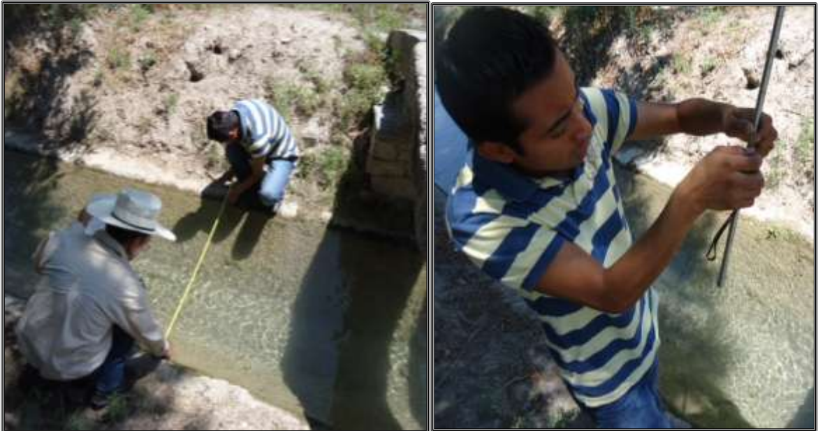
Figura 3.6 Medición del ancho del espejo del canal y tirante principal. (Fotografías tomadas por Norma Noemí Morales Pérez).
