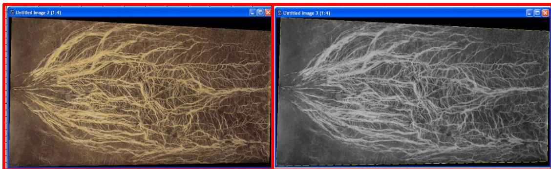
Figura 3.3 a) fotografía digital original en el programa ImageTool delimitando el área que no corresponde al suelo, y b) conversión de la fotografía a escala de grises
