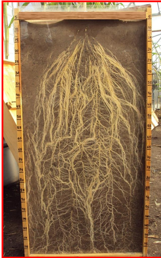
Figura. 3.2 Fotografía digital de una raíz de maíz dentro del rhizotron antes de iniciar el procesamiento digital
