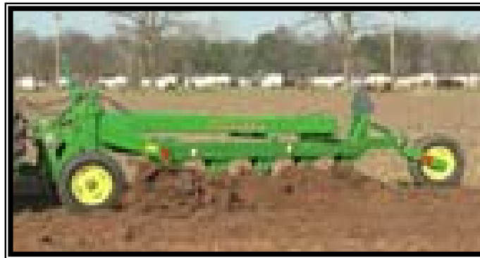
Fig. 1. Barbecho de terreno con arado descentrado de 5 vertederas (Foto: John Deere ®, 2003).
