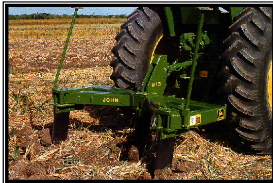
Fig. 14. Subsuelo de tres puntas con bastidor en “V”, rompiendo el piso de arado o piso de rastra. (John Deere ®, 2003)
