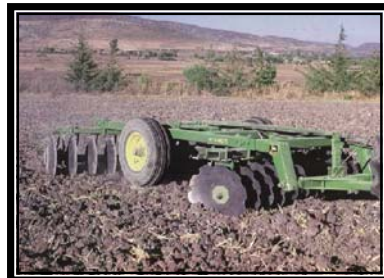
Fig. 2 y 3. Rastreo de terrenos para la eliminación de terrones con rastras integrales y de tiro. (Fotos: John Deere ®, 2002).
