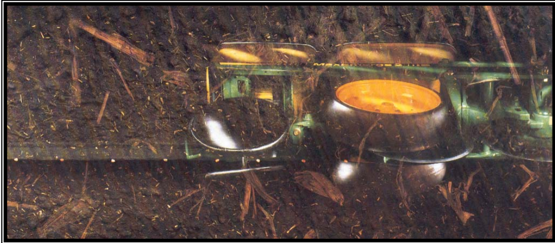
Fig. 17. Prueba realizada por John Deere ® sobre un cristal, en donde se comprueba la precisión en distancia y profundidad en la que se deposita la semilla (2002).
