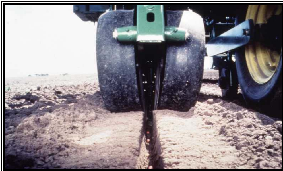
Fig. 16. Sistema de disco cortador o abridor de suelo John Deere ® para la siembra de semilla. (Fig. John Deere, 2000).
