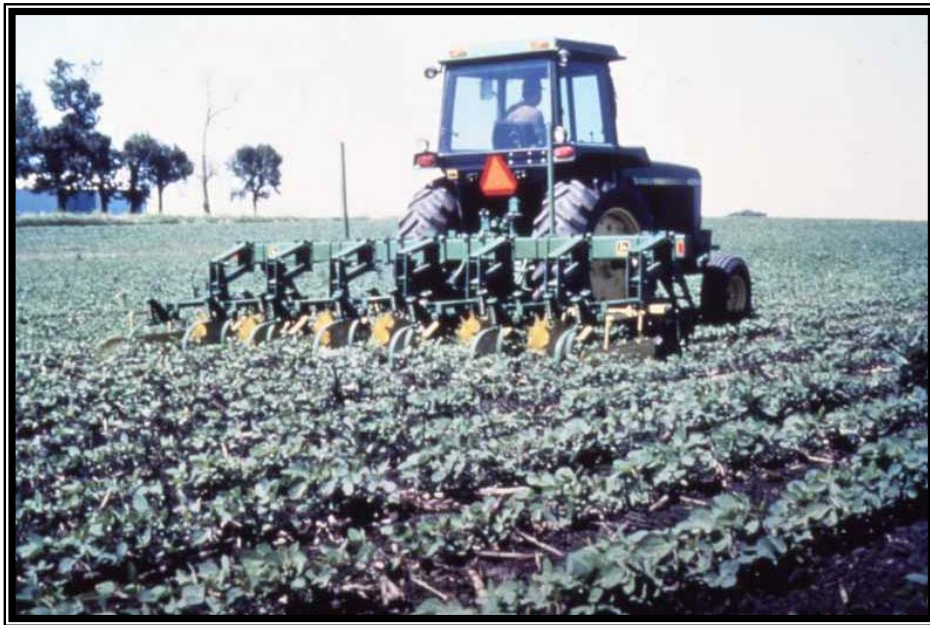
Figura 6. Práctica destinada para la eliminación mecánica de malas hiervas en un cultivo previamente establecido (Foto John Deere ®, 1990).
