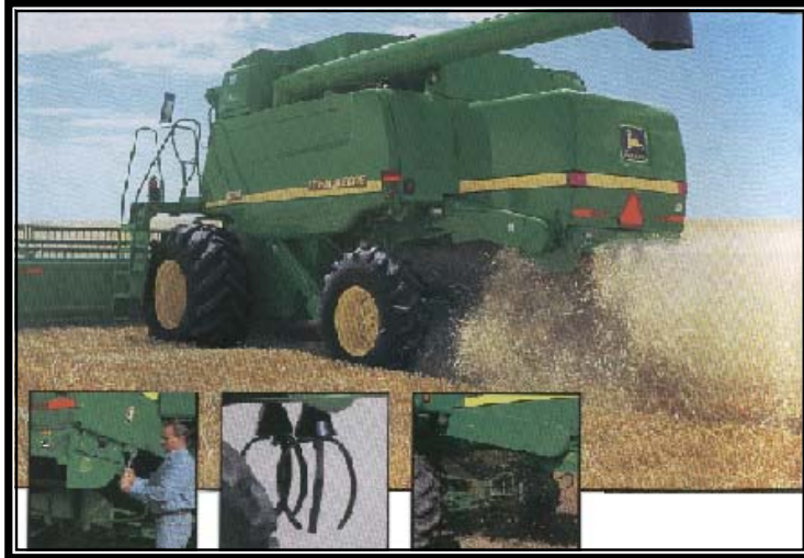
Figura 10. Cosechando y a la vez asperjando los residuos de la cosecha de manera uniforme, con el propósito de cubrir nuestra área de cultivo. (John Deere ®, 2003).
