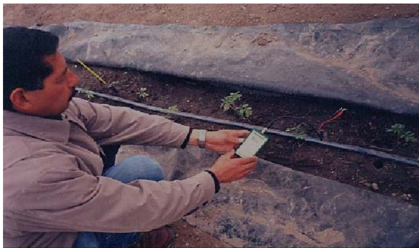
Figura 14. Equipo para determinar el contenido de humedad en suelo, Watter Mark,
