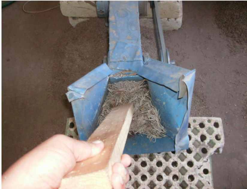
Figura 6. Se aprecia una regla empujando a la planta epifita hacia el interior del molino de martillos, y no tener accidentes con la mano.
