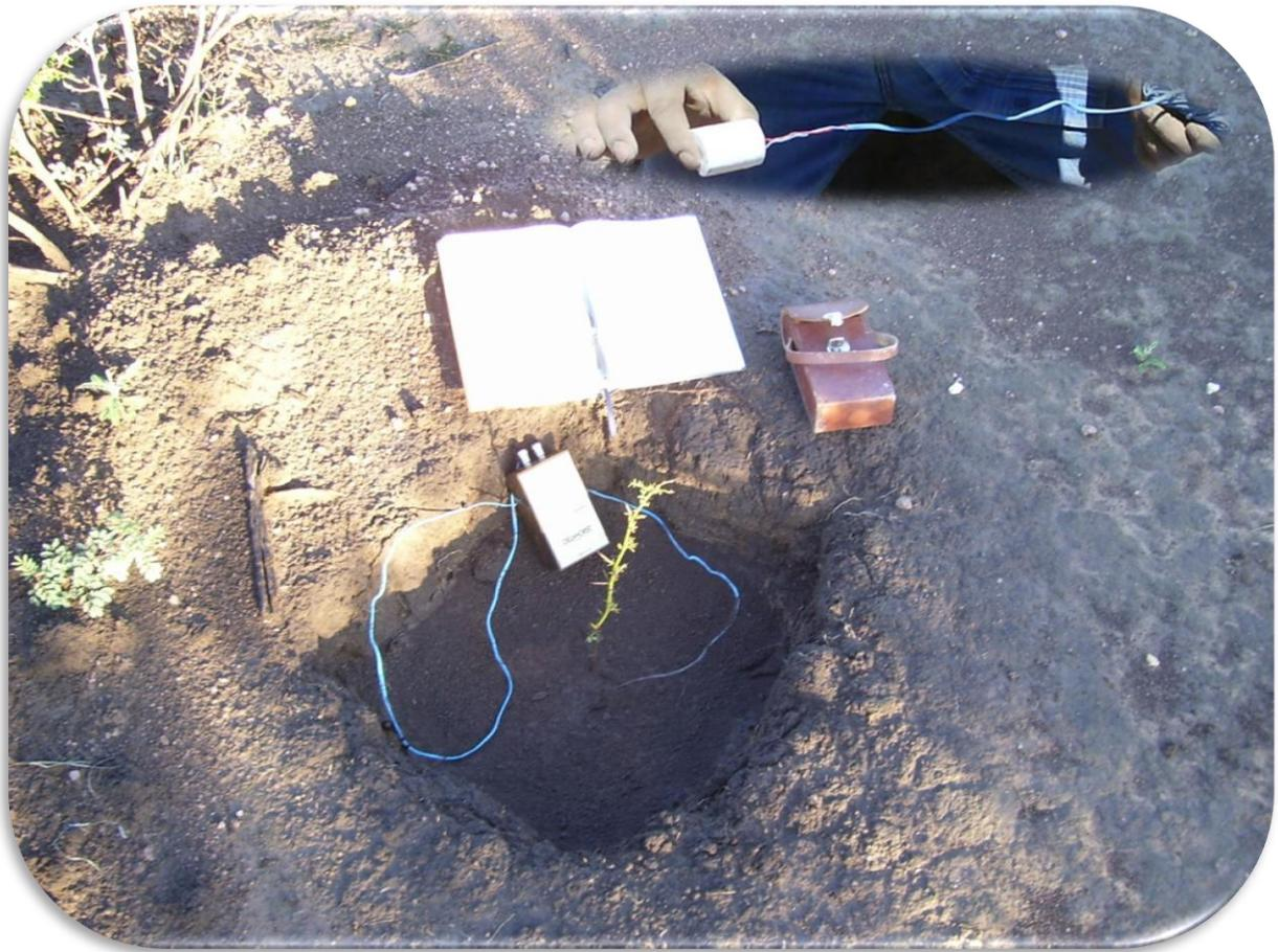
**Figura 17.** Sensores de yeso contruidos para medir la disponibilidad de humedad en el suelo con apoyo de un higrómetro.
