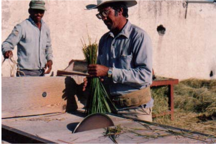
Figura 6. Despunte y dimensionado del cortadillo (García, 1999).
