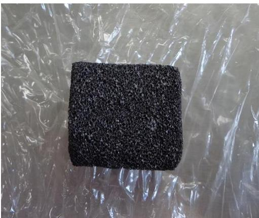
Figura 3.1. PU recubierta con grafito en aerosol.
