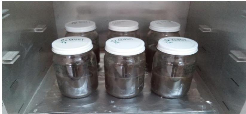
Figura 3.3. Proceso de acondicionamiento de electrodos.
