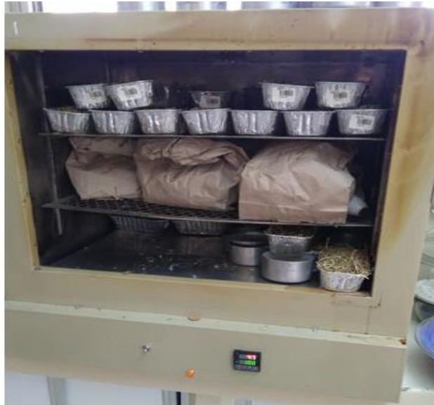
Figura 11. Colocación de las muestras en la estufa a 72 °C durante 24 horas para el secado de las muestras.
