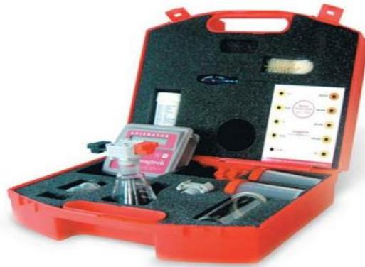
**Figura 17.** Arsenómetro WAGTECH 10500
