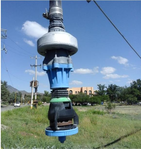
Figura 3.2 Rotor del pivote central de la UAAAN.
