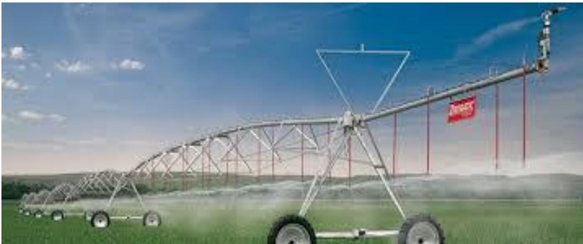
Figura 2.1 esquema de un sistema de riego tipo pivote central.
