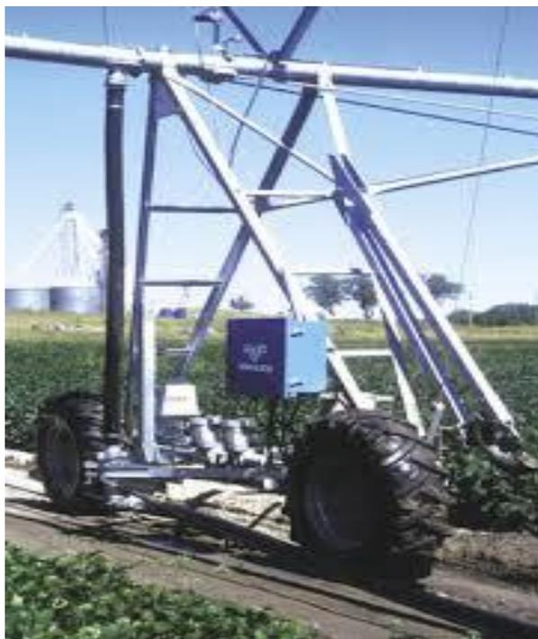
Figura 2.4 Sistema de propulsión de un lateral pivote.
