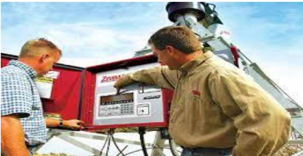
Figura 2.6 Tablero de control de un sistema tipo pivote central.
