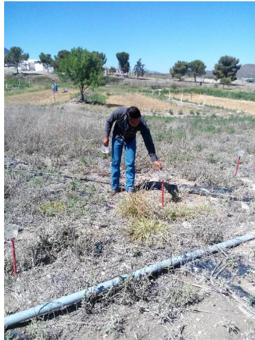
**Figura 13. Colocación de los botes colectores sobre la estaca**
