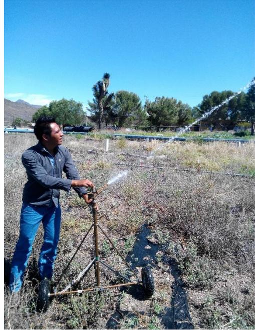
**Figura 15. Calibración del aspersor**
