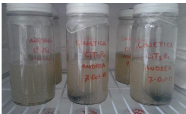
Figura 3.2. Reactores batch cinética de remoción biológica.
