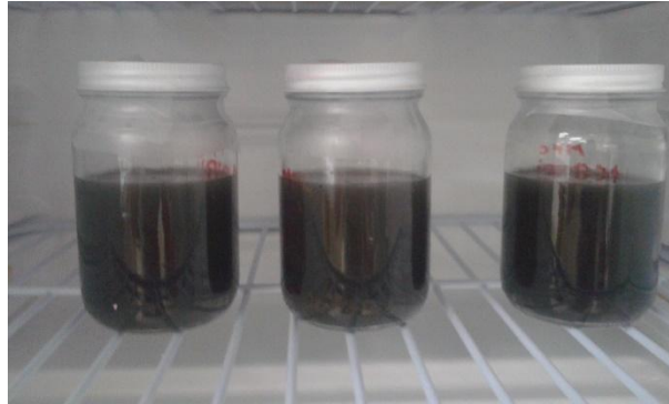
Figura 3.1. Reactores batch de acondicionamiento.
