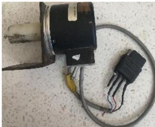
**Figura 4.8: Sensor rotativo ENCODER y colores de conexión**
