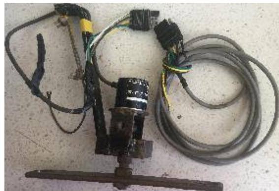
**Figura 4.11: Sensor ENCODER con cableado correspondiente**
