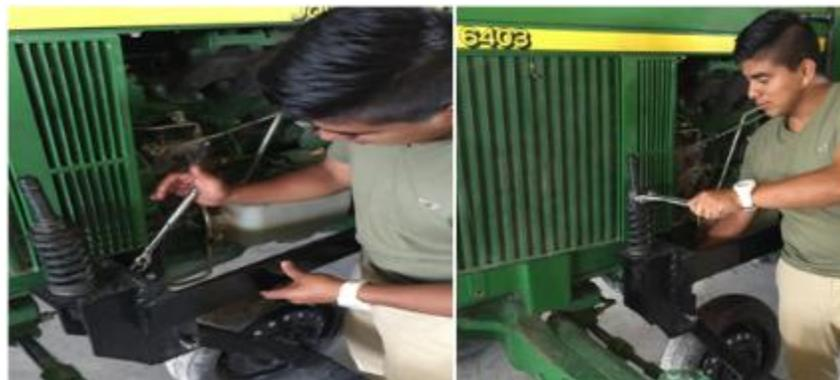
**Figura 4.6: Montaje del bastidor**
