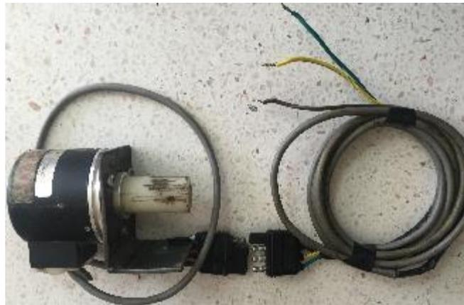
Figura 4.9: Cableado correcto para el sensor OMRON modelo e6b2-cwz6c de 64 pulsos/giro
