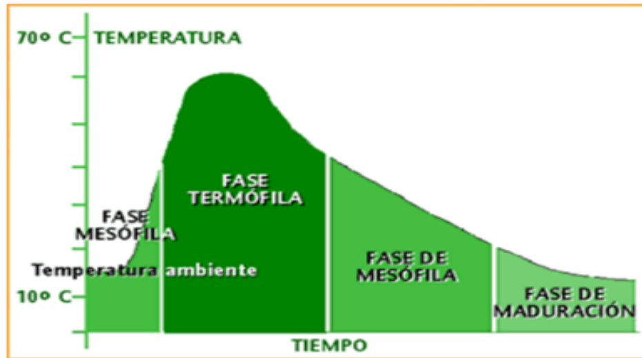
Figura 3. Etapas de temperatura en el proceso de compostaje.
