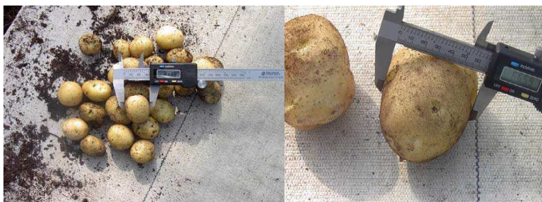
Figuras 3.3 y 3.4 .- Vernier electrónico, que se utilizó para la determinación de los diámetros polares y ecuatoriales de los minitubérculos.
