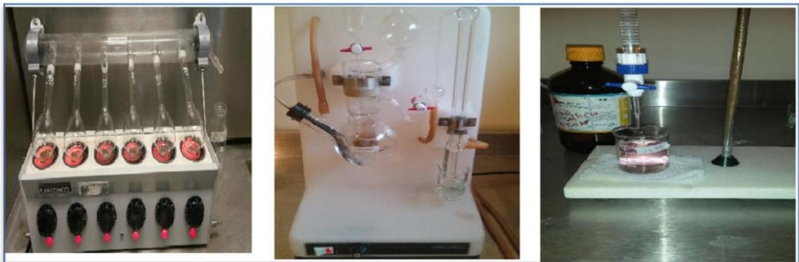
**Figura 14. Digestión, Destilación y Titulación para determinación de proteína**
