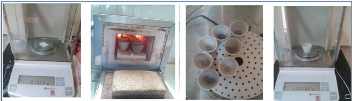
Figura 17. Determinación de cenizas
