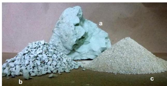
Figura 6. a) Roca natural de zeolita, b) Zeolita molida a un tamaño de partícula de 3 mm y c) Zeolita molida a 0.50 mm.
