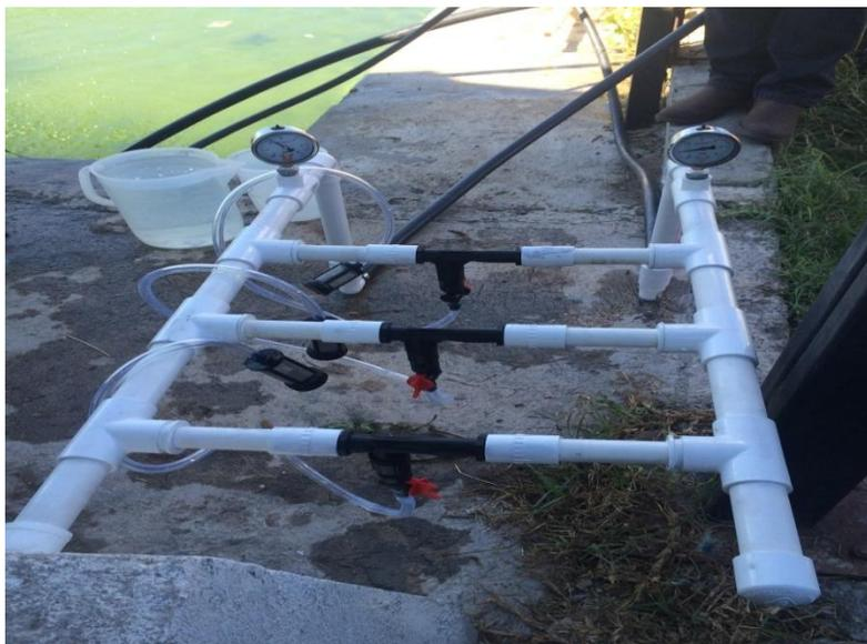
**Figura 3. 3 Equipo de inyección instalado en el jardín Hidráulico.**
