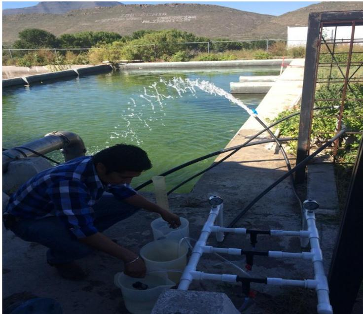
**Figura 3. 4 Equipo de inyección tipo Venturi succionando la solución.**
