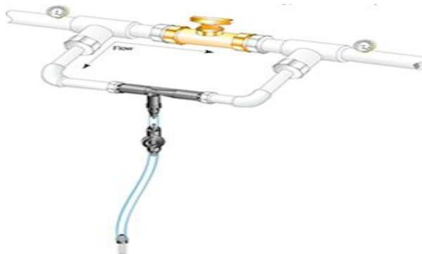
**Figura 2. 4 Inyector Venturi conectado en paralelo a una válvula sencilla.**
