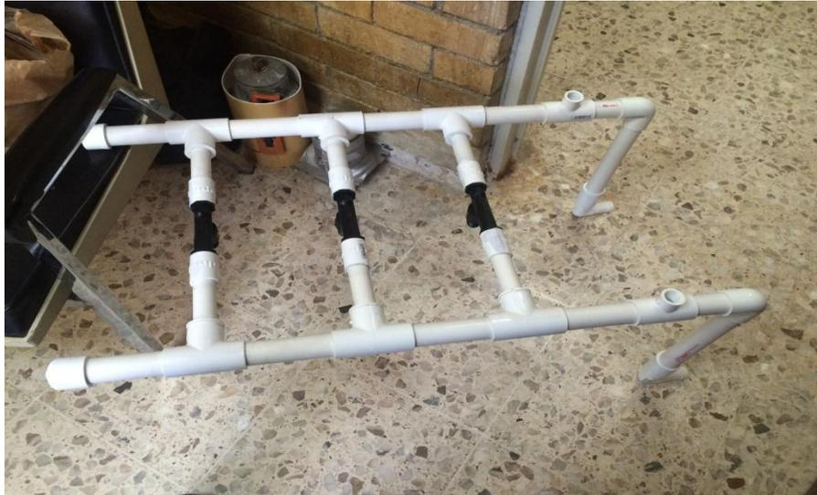
**Figura 3. 1 Ensamble del equipo de inyección múltiple tipo Venturi.**
