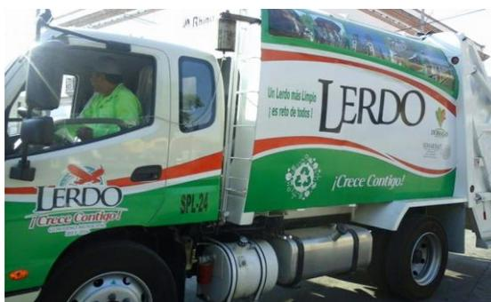
**Figura 19. Vehículo compactador de carga trasera.**
