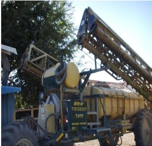
**Fumigadora con aire.** Es una máquina con la capacidad de 2850 litros de agua que mide 24 metros el aguilón y con un tractor Ford 8010 de alto despeje y con velocidad 4<sup>a</sup>. fumiga 20 has con una sola carga y con velocidad 3<sup>a</sup> nos fumiga 17 has.
