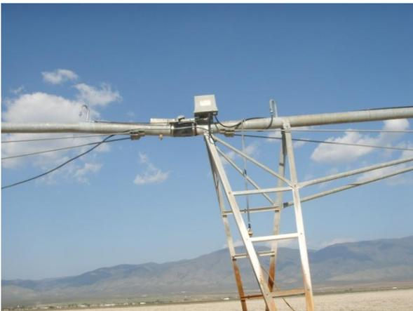
**Unión de torres.** Una caja de control se encuentra en cada torre de conducción. Unos cables de código de color entran y salen de cada caja. Por lo tanto, el cable recorre toda la longitud del sistema. El cable lleva dos tipos de carga eléctrica, 120
