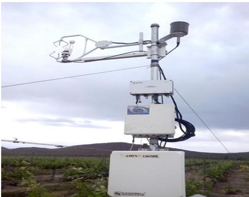
Figura 1. Sensores de un sistema Eddy sobre una plantación de vid para medir los flujos de bióxido de carbono entre el dosel de la plantación y la atmósfera circundante.
