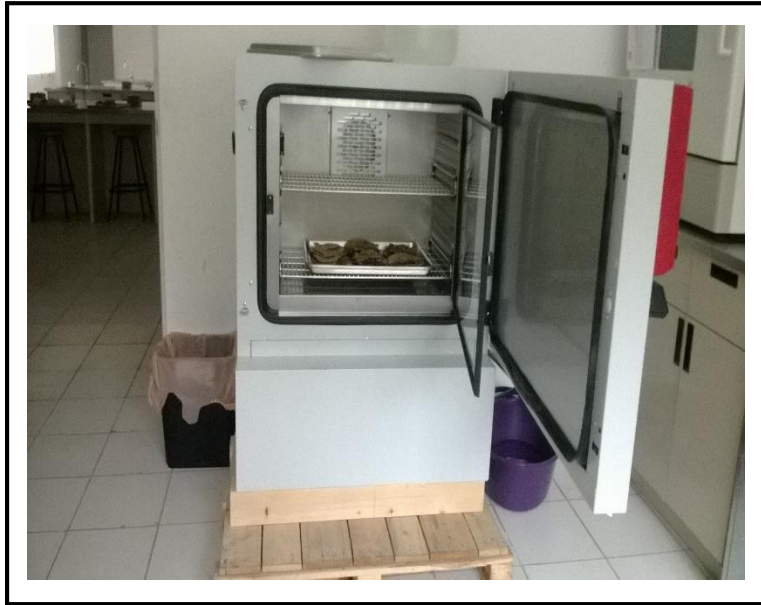
Figura 10. Exposición de tortillas en cámara bioclimática
